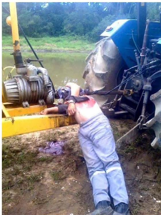
**Figura 9. – Cenário de esmagamento de operador por eixo da tomada de força sem proteção**
