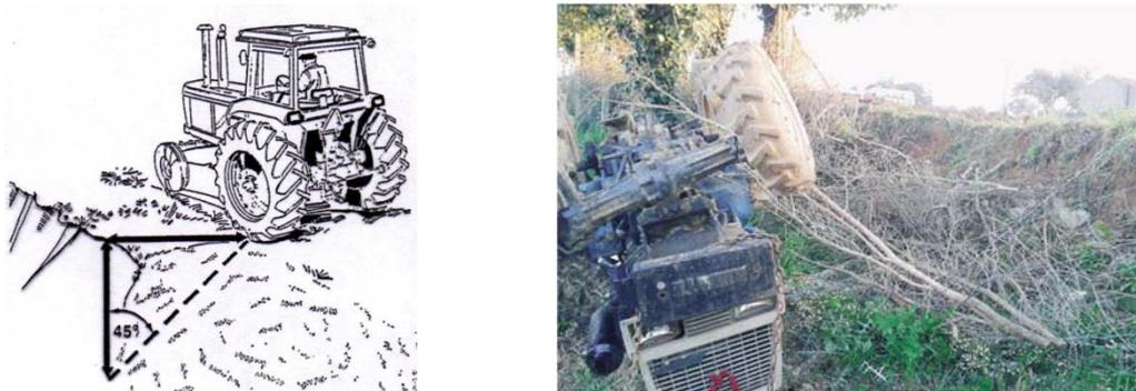
**Figura 5. – Cenário de capotamento de trator agrícola por circulação sobre um talude instável**
