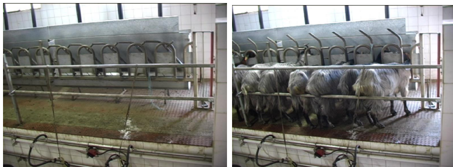
Figura 4 - Sala de ordenha com sistema tipo “Casse” para cabras de raça Serrana.
