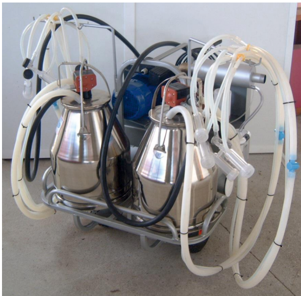
Figura 11 - Máquina de ordenha portátil (2 baldes, 4 postos).
